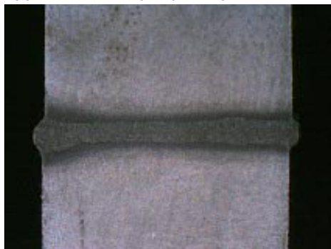
Figure 1 Soudure laser autogène sur acier de construction, épaisseur 1/2", une seule passe, sans préparation
